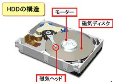
磁気ディスクはアルミ基板とガラス基板があり、据え置き型のHDDはアルミ製ディスクが多く、ノートパソコンなどモバイル型や車載用などは2.5インチ、1.8インチのサイズの磁気ディスクで耐衝撃性の優れたガラスディスクが使われている。
