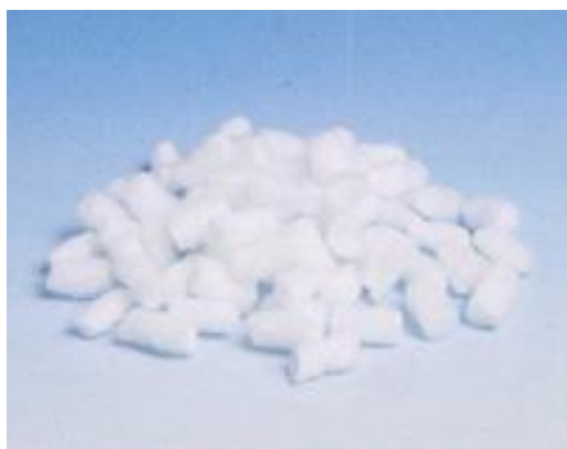
ポリエステル繊維ろ材【日立造船HPより】
