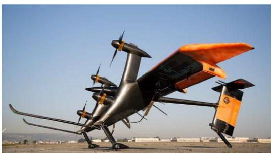
グライダー型空中風車も考えられている。上空の高速風の利用、タワーと基礎工事の費用削減、等が利点である。しかしながら、安全性、地上への送電等でまだ課題が残る。
