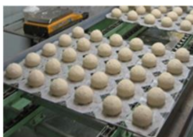
製造ロットの印字された敷き紙を使って生産
