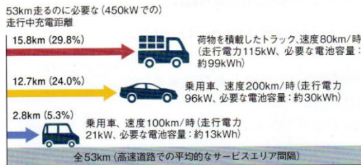
図7 450kWで充電なら一般の乗用車の充電は走行距離の約5%で済む ホンダの走行中充電実験の結果の一部を示した。450kWで充電する場合、100km/時で走る乗用車なら走行区間の約5%だけ充電すれば、残りは無給電で走れる。トラックなら区間の約30%で充電が必要になる。(図：ホンダの論文 3) を基に本誌が作成)
