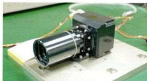
図5 世界最高レベルの性能を持つ小型衛星用のスタートラッカー
