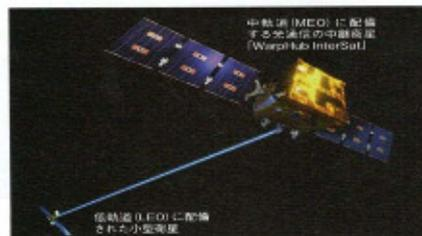
図8 中軌道の中継衛星から地上にデータを下ろすワープスペースは、低軌道の衛星のデータをとった中軌道に配備した中継衛星に光通信で送り、そこから電波で地上に下ろすサービスの開発を進めている。22年から3基を中軌道に打ち上げ、23~24年のサービス開始を目標としている。(図:ワープスペース)
