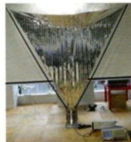
図5 大気圏突入までの時間を4分の1に短縮する薄膜展開型機構
