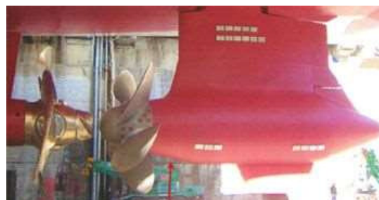
【 図14、ハイブリット型CRPポッド搭載 高速フェリーのプロペラ 】
