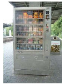
ドイツ ケルン駅半屋外設置機 フロントガラスには盗難防止用の金網入り
